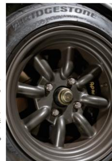
フロントに7.5J、リアに9Jを装着した足まわり。ホイールはRSワタナベ。通常よりもリムの深いサイズを特殊な加工により装着している。ブレーキはAPロックード製の4ポッドに変更済み。
