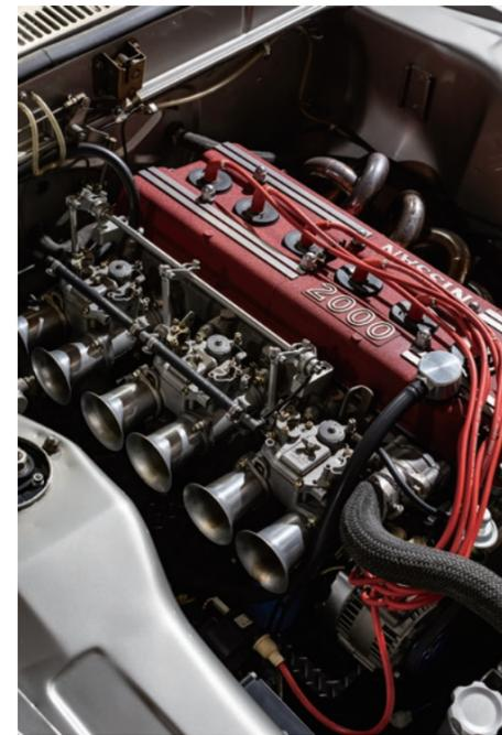
美しいディテールが見えるものを圧倒するS20型エンジン。岩橋さん曰く、3.1リットルまで排気量を拡大したチューニング済みのL28型エンジンと比較すると、S20型エンジンはトルクも細くて乗りにくいそうだ。
